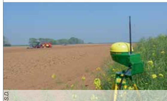
La station RTK mobile, déplacée de champ en champ, offre un rayon d'action d'environ 15 km.
