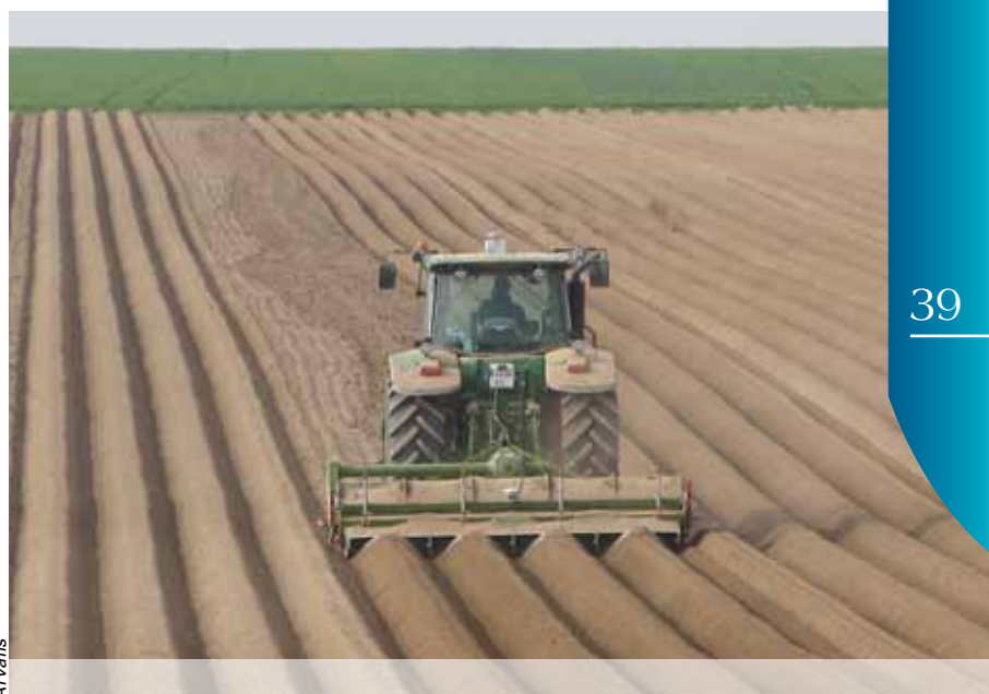
Arvalis a mesuré la précision de l'outil de préparation en prébottage alors que le tracteur est autoguidé en GPS RTK.
